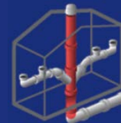
AUSKLEIDUNG DER FALLEITUNG
