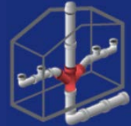
AUSKLEIDUNG VON ANSCHLUSSROHREN
